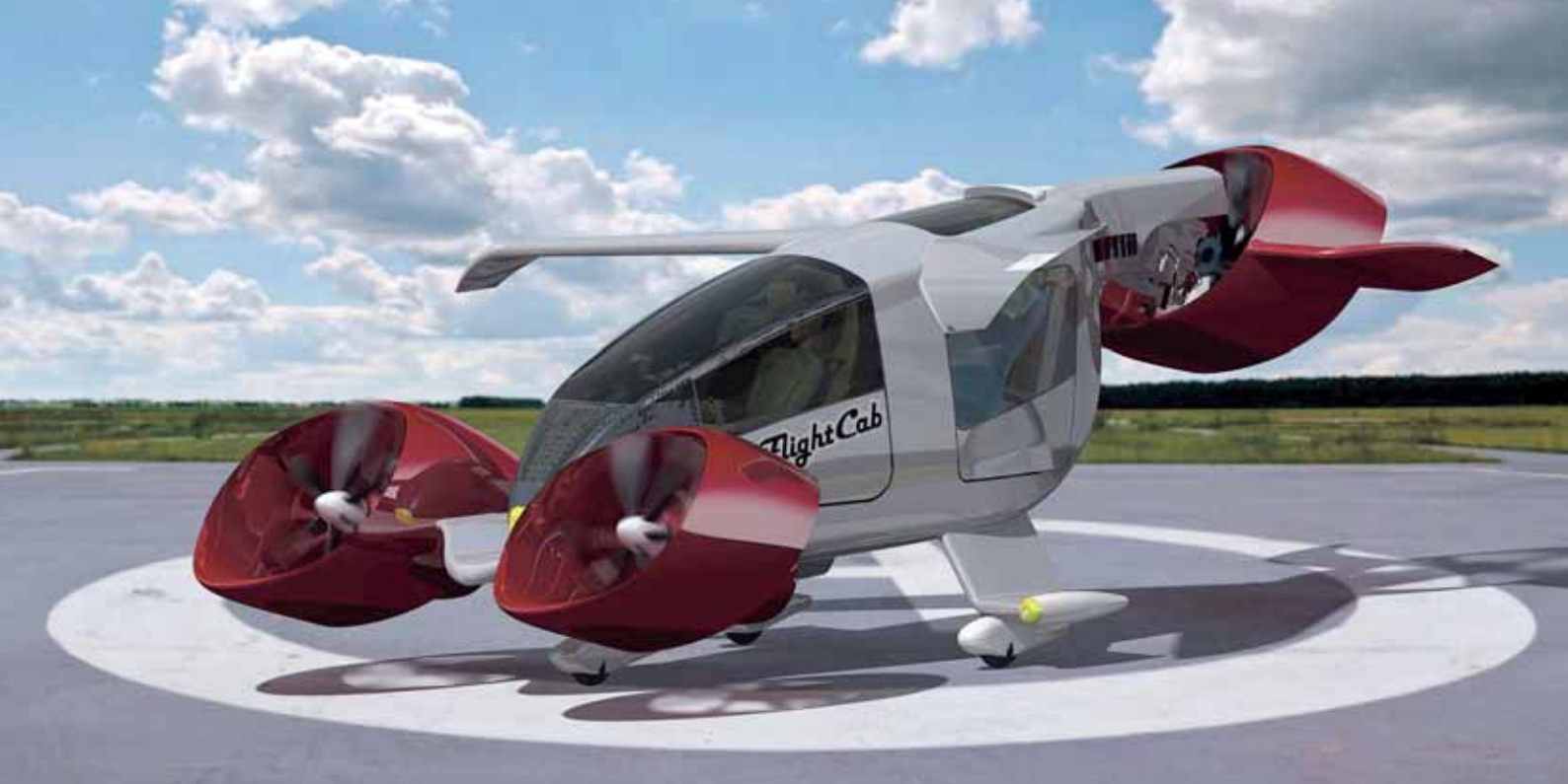
Le concept de voiture volante FlightCab propulsé par trois moteurs Wankel de 190 HP chacun, à 6000 tr/mn.
