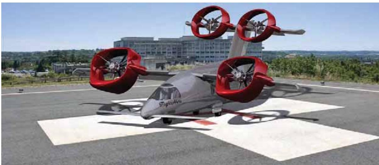
La particularité principale du FlightHero concerne le concept de propulseurs hypersustentateurs.
